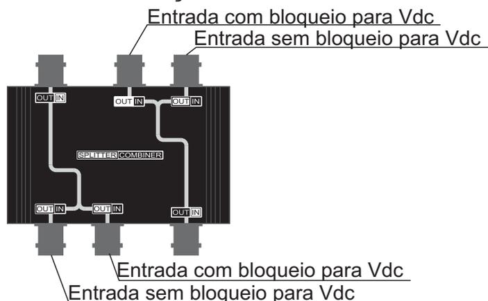
Para liberar a passagem de corrente Vdc em todas as entradas será necessário uma chave de torx T10, um soldador e uma pinça. Remova a tampa superior soltando os 4 parafusos superiores, substitua capacitor C1 pelo resistor R1 e o capacitor C2 pelo resistor R4.
