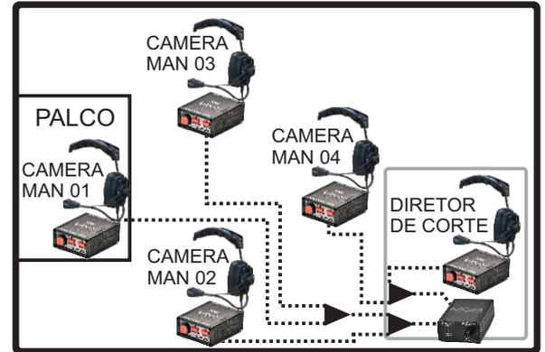
Sistema de 4 pontos e 2 sinalizadores para a equipe de audio e 1 sistema de 3 pontos para a equipe de iluminação alimentados por uma fonte PS 1.
