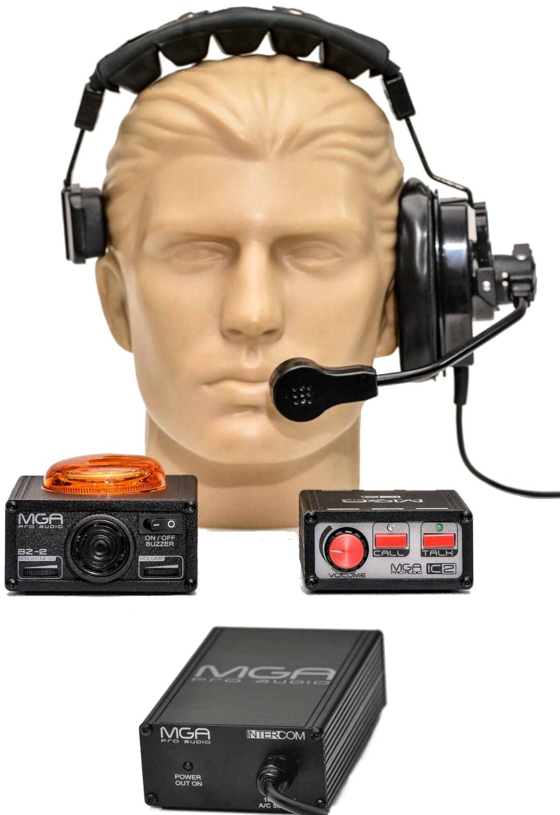
As conexões dos aparelhos são feitas em cascata ou em paralelo utilizando as duas saídas da fonte de alimentação. A distribuição do sinal também pode ser feita com um splitter de sinal passivo e não isolado.
